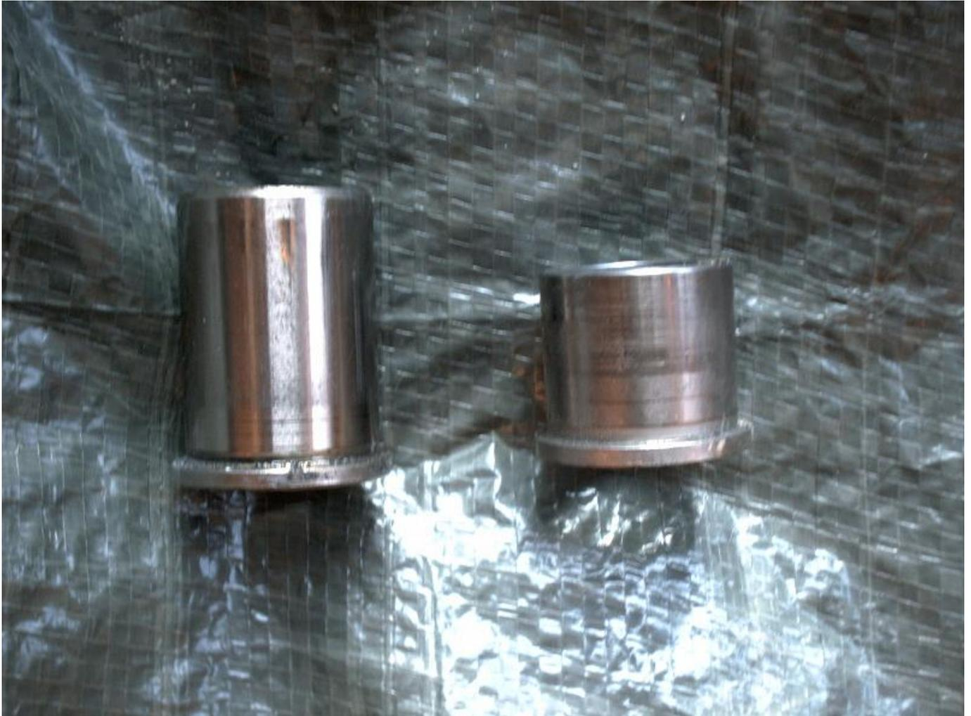
Ich habe das Innenrohr neu angefertigt, damit ich die Hülse an der Kettenseite (hier links) original lassen konnte.
