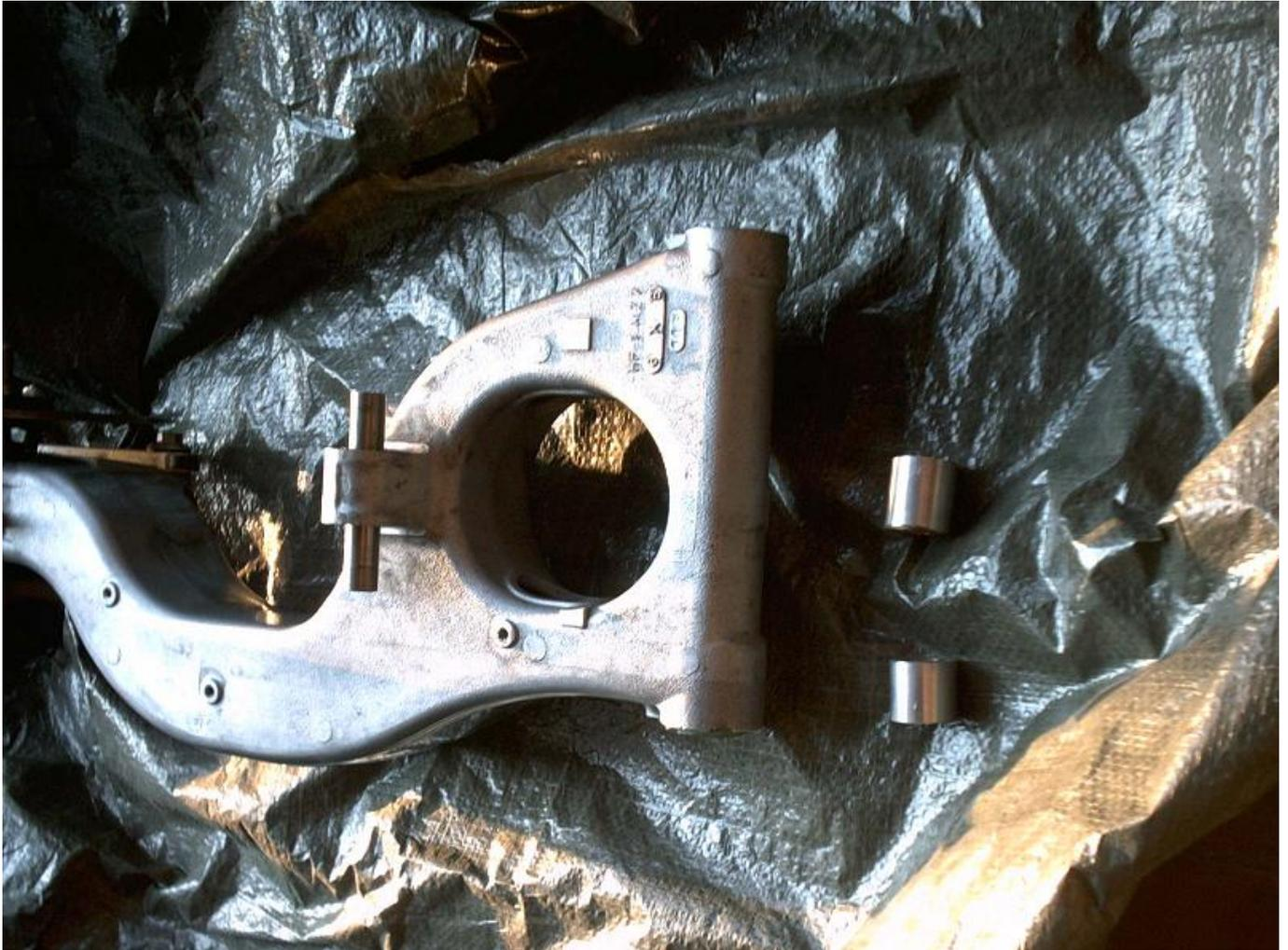
Es werden auch sämtliche Achsen der FZR weiterverwendet. auf dem Bild sieht man den FZR Schwingenbolzen in den Lagern der RC36. Rechts daneben die selbst gedrehten Aludistanzen, welche einfach auf die Seiten des
