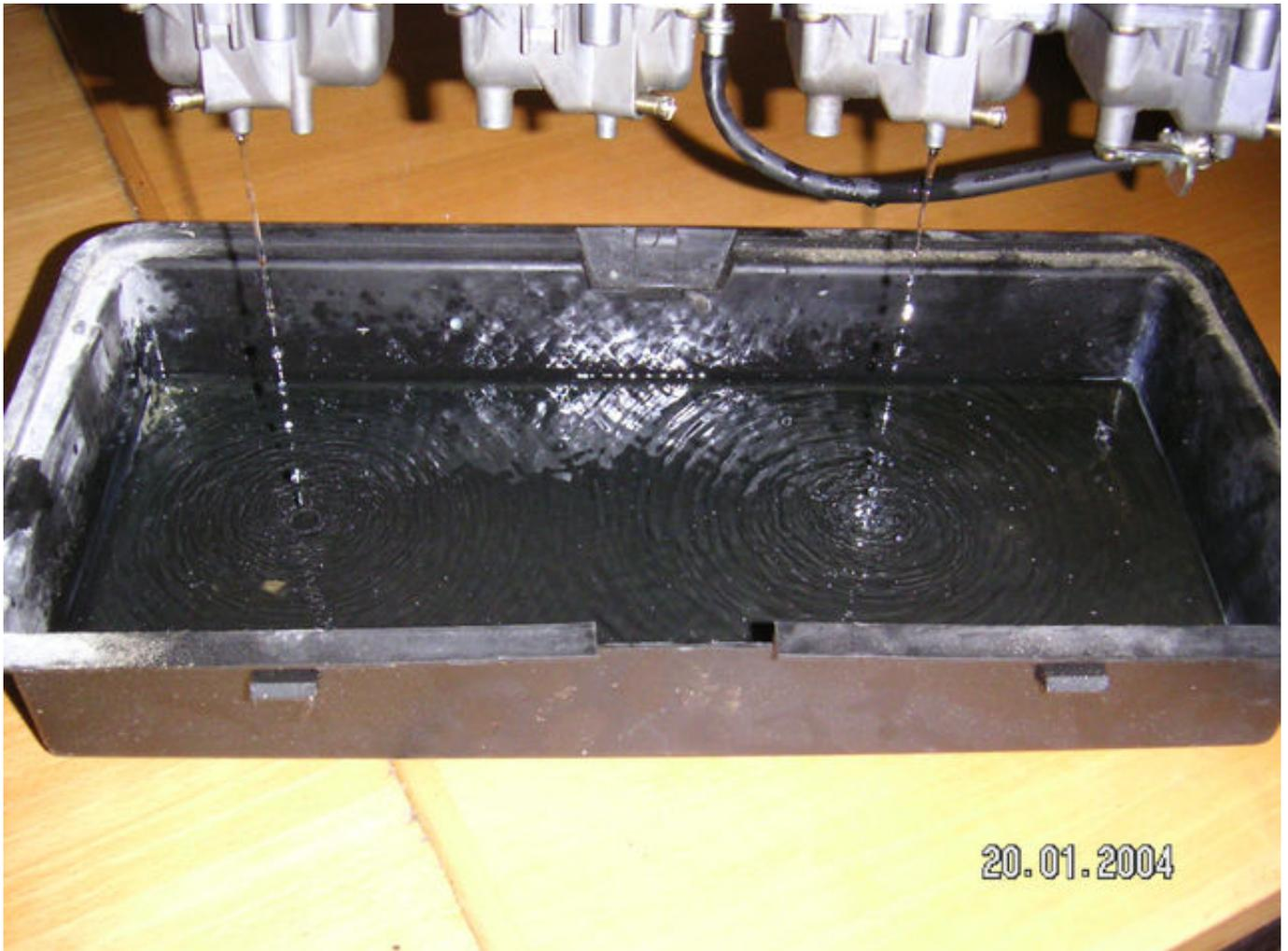
Schwimmerkammern der Vergaser leeren durch aufdrehen der vier Ablassschrauben.
