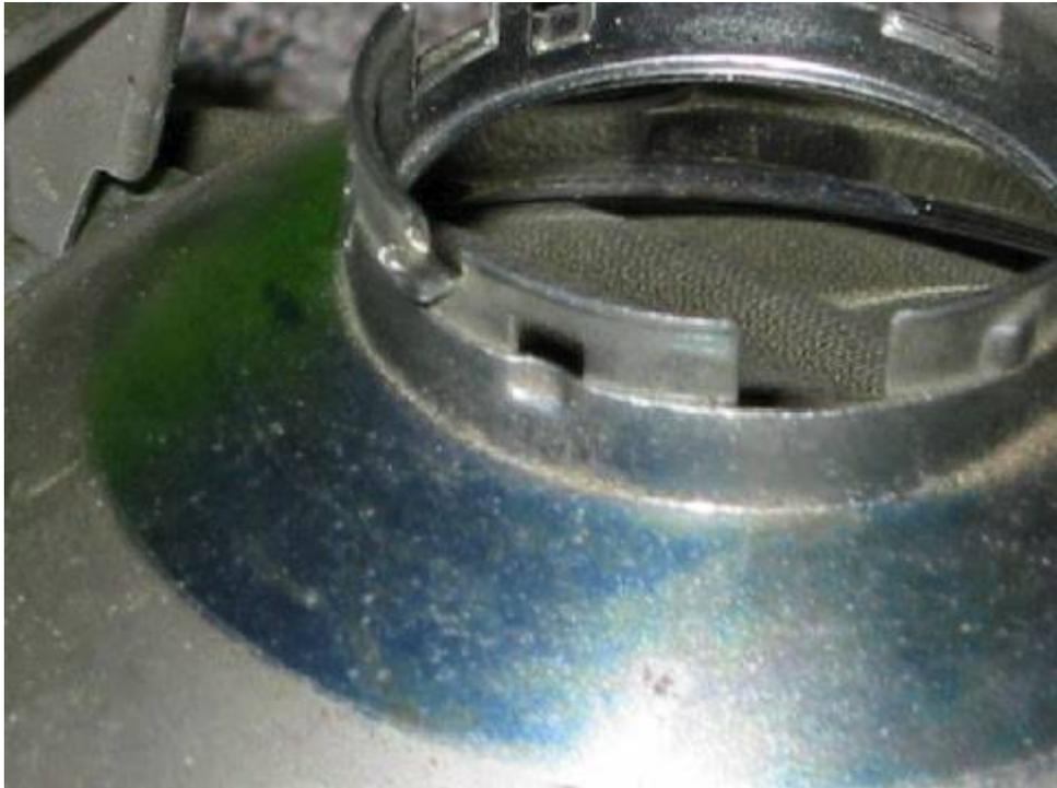
Die biegst Du leicht nach aussen, dann nimmst Du den Ring heraus. Am zweiten Scheinwerfer ebenso. Nun nimmst Du den Ring des Abblendscheinwerfers und setzt es in den Reflektor des Fernscheinwerfers ein (Der Reflektor ohne Standlichtloch :))
