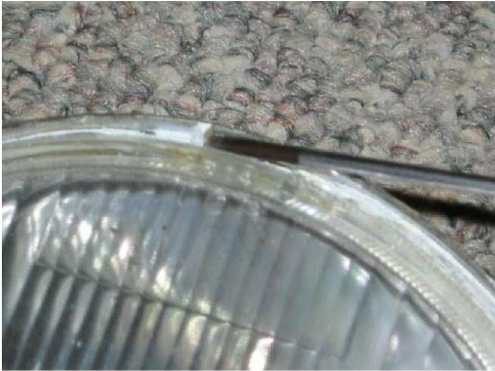
Wenn Du das Größte weg hast, geh mit dem Messer in den kleinen Spalt zwischen Scheinwerferglasrand und Reflektorrahmen und schneide/kratze auch hier alles von dem grauen Dreck raus.
