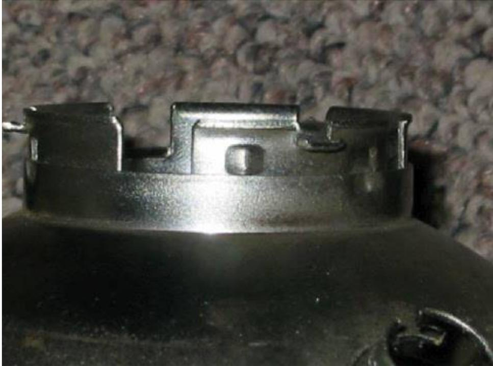
Zur Sicherung die Blechkante in die vorhandenen Löcher des Rings eindrücken.
